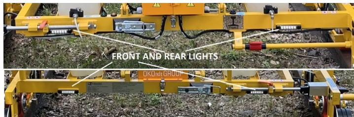
Las características de diseño del UDS2-73 SWP incluyen elementos instalados en el chasis para iluminar la parte frontal de la vía y la zona de tránsito del operador, lámparas LED para iluminar el área de inspección, los dispositivos de medición y las ruedas (SWP), así como la iluminación de la barra.
