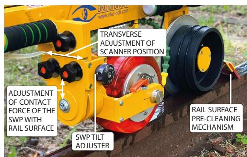
El posicionamiento de cada rueda de escaneo se logra mediante ajustes mecánicos.
