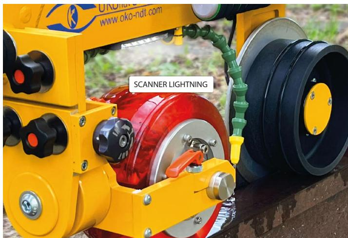
El detector de fallas está equipado con dispositivos especiales que garantizan la trayectoria fiable del movimiento del detector de fallas en interruptores y travesaños independientemente de la dirección del movimiento. Esta función permite realizar pruebas interrumpidas en toda la vía ferroviaria.
