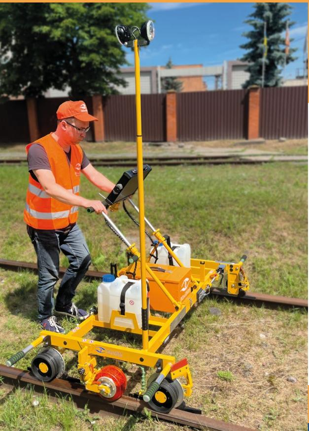
La posición de la unidad electrónica de control y visualización (monitor) puede ajustarse en tres ejes. La unidad electrónica tiene clase de protección IP65 según EN60529
