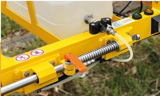
El diseño incluye un mecanismo que asegura que la rueda de escaneo se mantenga siempre en la posición óptima con respecto a la cabeza del riel durante la inspección.
